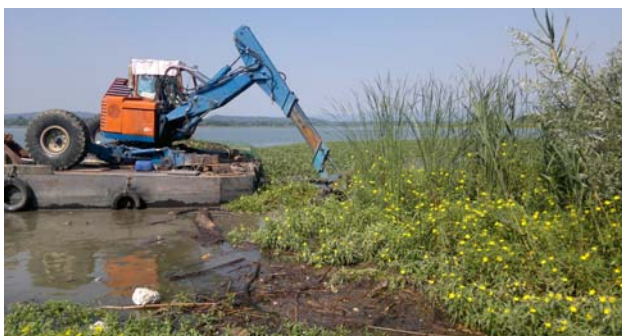
Figura 14 Estirpazione meccanica delle parti sommerse nel PLOT Valle Luna [fonte: foto Idrogea]
